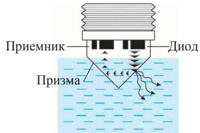
Датчик погружен в жидкость
