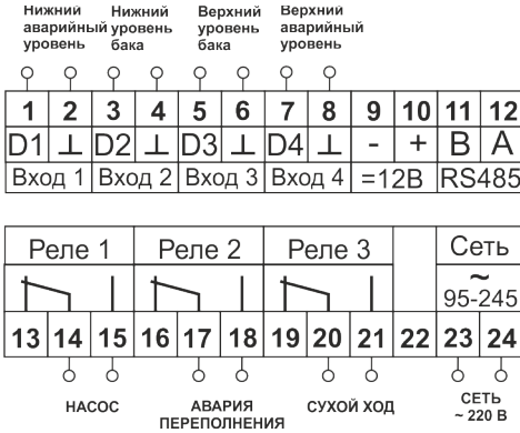
Рис. 5.7 Алгоритм 4: схема подключения
